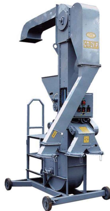
Рис. 1. Конструктивно-технологическая схема (а) и общий вид (б) опытного образца пневмосепаратора СП-2У-Р для очистки от примесей семян трав и зерна: 1 – ротационный поперечно-поточный пылеуловитель; 1 – вентилятор; 2 – пневмосепарирующий канал; 3 – ротационный пылеуловитель; 4 – пылеосадительная камера; 5 – тканевый фильтр; 6 – приемное устройство; 7 – дроссельное устройство; 8 – задвижка; 9 – смотровое окно; 10 – воздуховод; 11 – материалопроводы; 12 – сменная сетка; 13 – мешки
