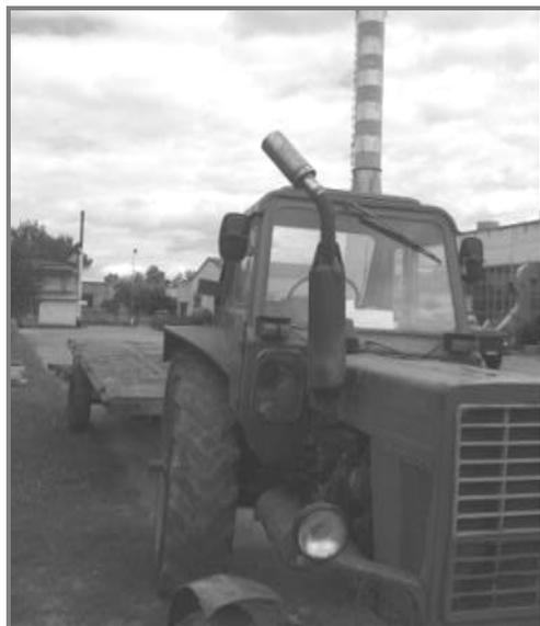
Рисунок 2 – Искрогаситель (выхлопная система МТЗ-80)
