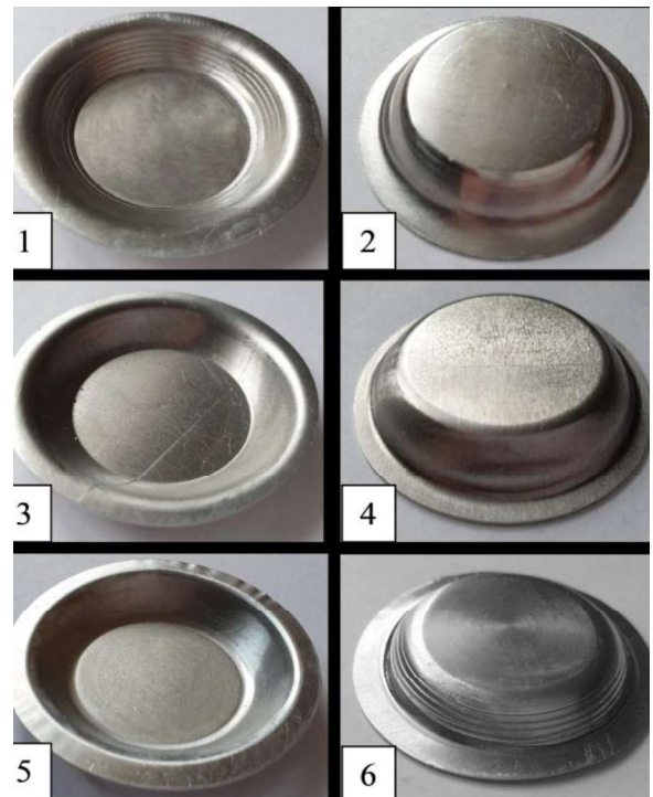
Рис. 1. Отштампованные образцы детали, верхней и нижней прокладок
