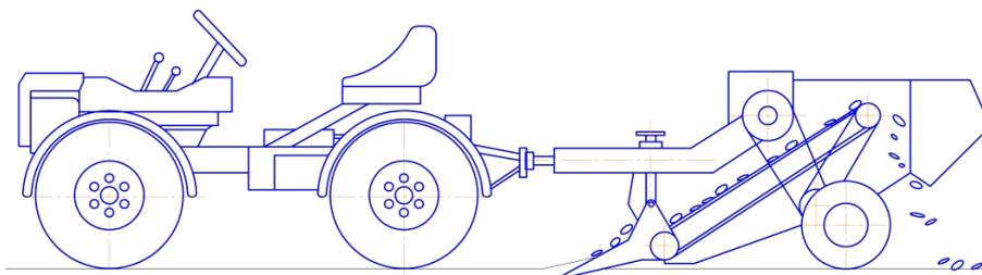
Рисунок 6 – Схема агрегата картофелеуборочного
