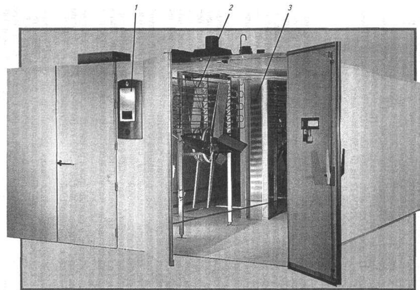
Рисунок 6.24 — Инкубационный шкаф «Петерсайм»: 1 — пульт управления; 2 — нагревательный элемент; 3 — лотки с яйцами
