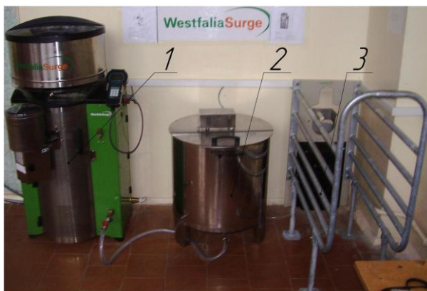
Рисунок 5.1. Общий вид установки для выпойки телят: 1 – автопоилка; 2 – емкость молочная; 3 – станок
