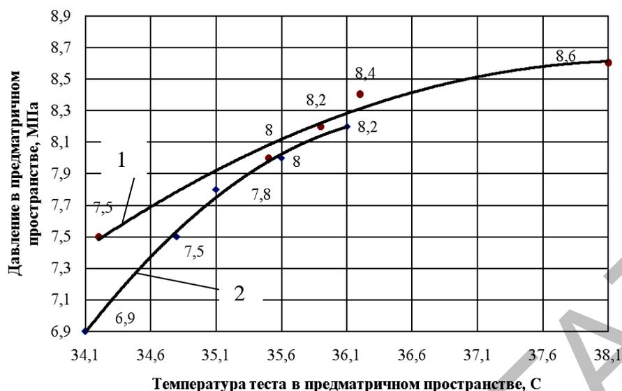
Рисунок 2 – Зависимость температуры теста в предматричном пространстве от давления:
