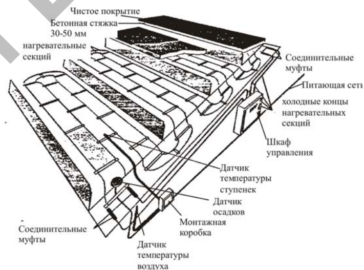
Рис. 3.12. Схема укладки и подключений кабеля при обогреве ступенек
