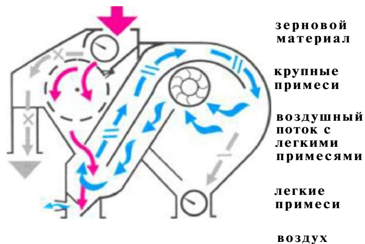
Рис. 3.154. Схема технологического процесса машины МПО-50С
