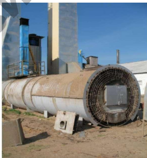
Рис. 3.90. Общий вид воздухонагревателя ВУ-Т-1,5
