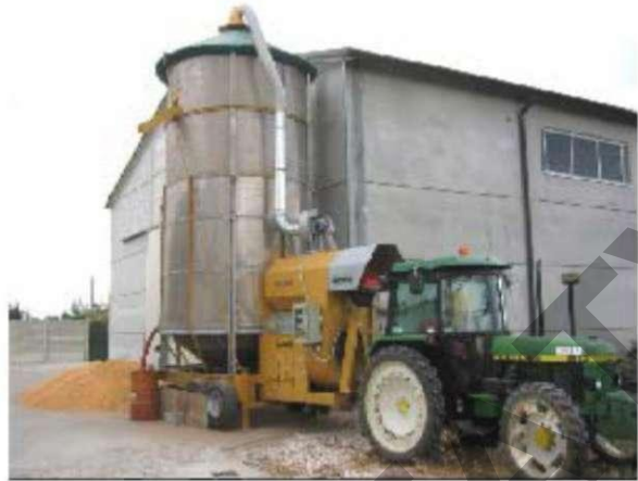
Рис. 3.59. Двойная выгрузка через решетки в склад или в прицеп
