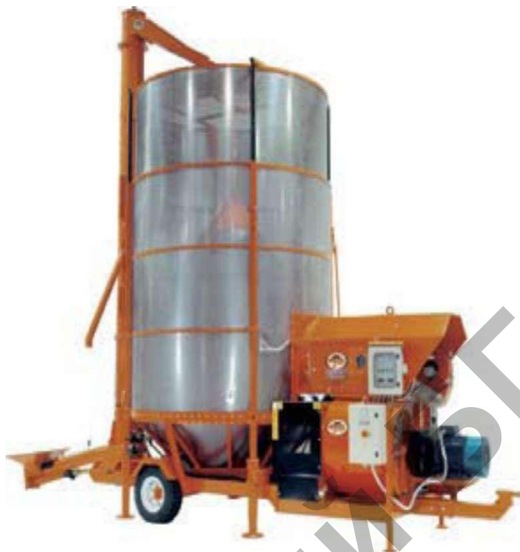
Рис. 3.32. Общий вид передвижной зерносушилки РКТ200МЕ 1/12
