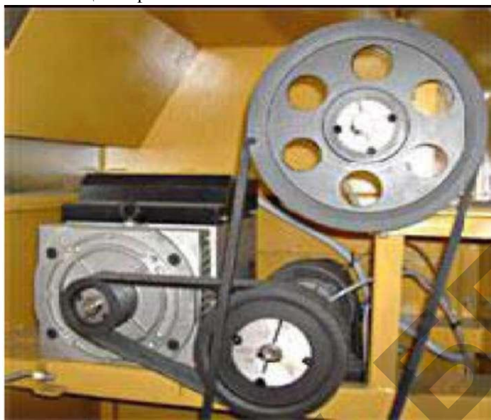
Рис. 3.40. Привод от одного электродвигателя с генератором
