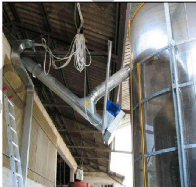
Рис. 3.60. Двойная выгрузка через решетки в склад через существующий транспортер или в прицеп
