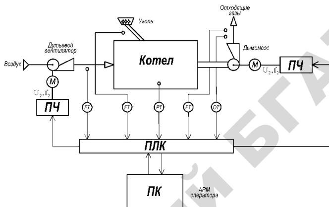
Рисунок 1. - Схема САУ тягодутьевым трактом котла
