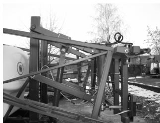
Рис. 1.25. Механизмы изменения высоты установки штанги
