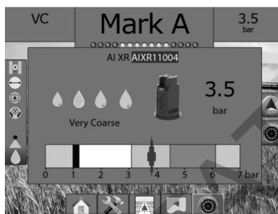
Рис. 1.21. Пример работы функции «Монитор размера капель». Данные навигатор получает от установленного в опрыскивателе датчика давления на шине CAN
