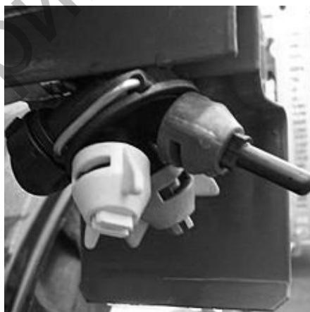
Рис. 1.11. Устройство отсечное мембранное:
