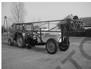
Рис. 6.4. Опрыскиватель «Мекосан-2500-18П» в транспортном ( а ) и рабочем ( б ) положениях
