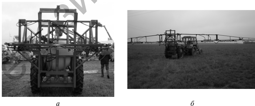
Рис. 6.8. Опрыскиватель ОШ-2300-18 в транспортном (а) и рабочем (б) положениях
