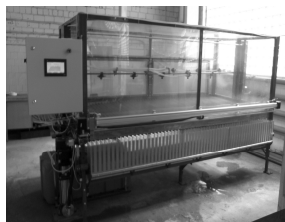
Рис. 5.1. Стенды для измерения параметров распылителей
