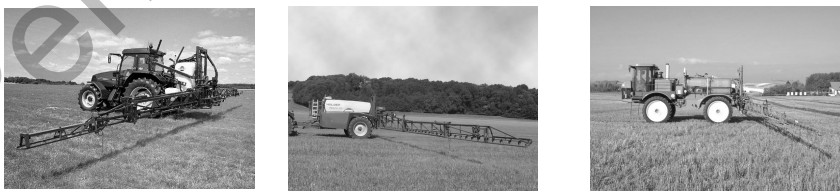
Рис. 1.14. Положение штанги в транспортном (а) и рабочем (б) положениях
