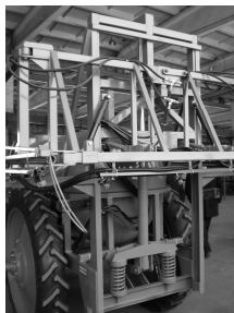
Рис. 1.25. Механизмы изменения высоты установки штанги
