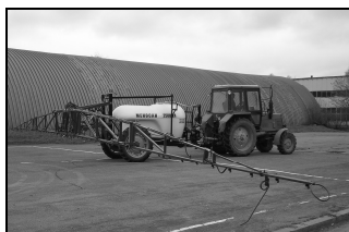
Рис. 6.4. Опрыскиватель «Мекосан-2500-18П» в транспортном ( а ) и рабочем ( б ) положениях
