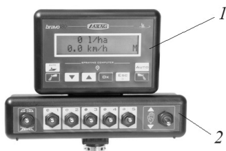
Рис. 1.18. Компьютерный блок: 1 – монитор; 2 – блок управления клапанами секций штанги
