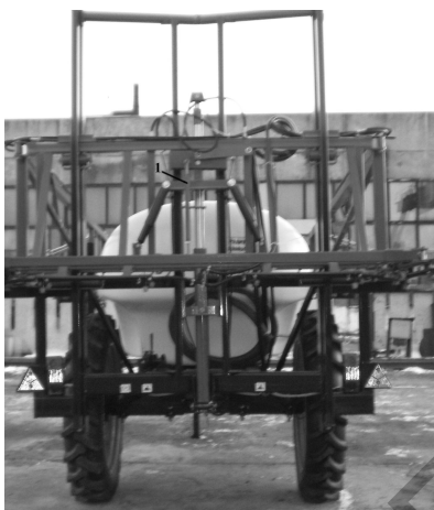
Рис. 4.3. Механизм изменения угла наклона штанги механического действия
