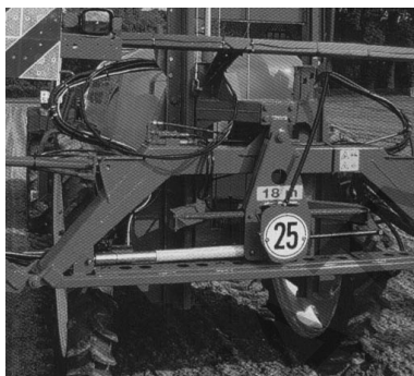
Рис. 4.5. Механизм регулировки угла наклона штанги фирмы Amazone
