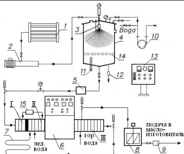
Рисунок 1 - Технологическая схема аппаратного оформления поточного двухстадийного созревания сливок
