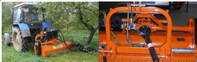
Рисунок 2 – Косилка – измельчитель: а) – общий вид; б) – механизм бокового смещения
