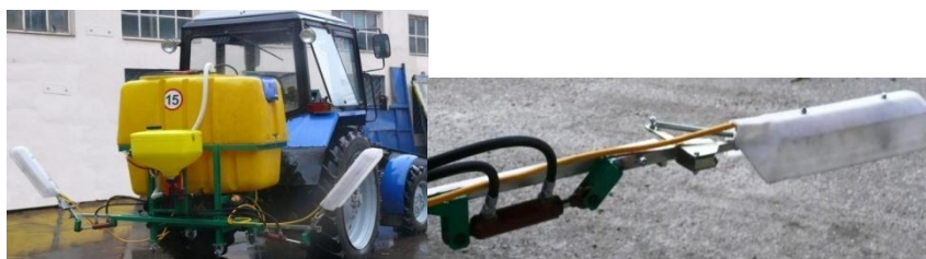
Рисунок 5 – Устройство для внесения гербицидов в приствольную зону
