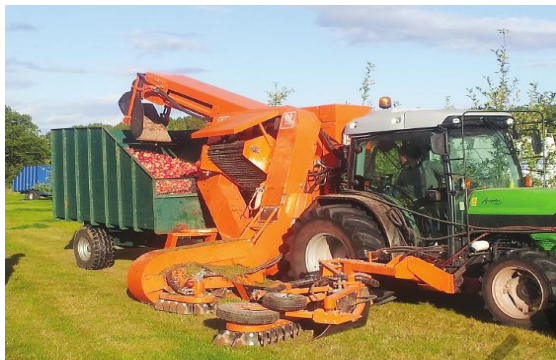
Рисунок 1 – Прицепной комбайн для уборки плодов с земли Tuthill Centipede 2015 Harvester производительностью 15 т/ч
