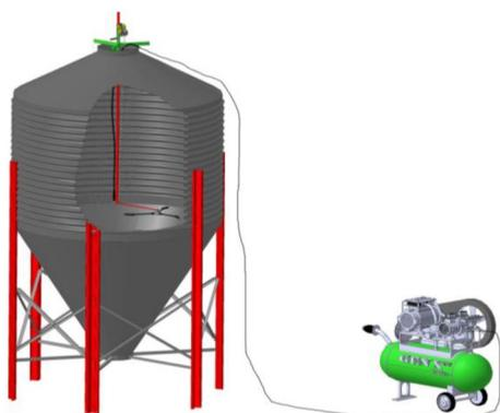
Рисунок 10. – Схема очистки внутренней поверхности бункеров струей сжатого воздуха
