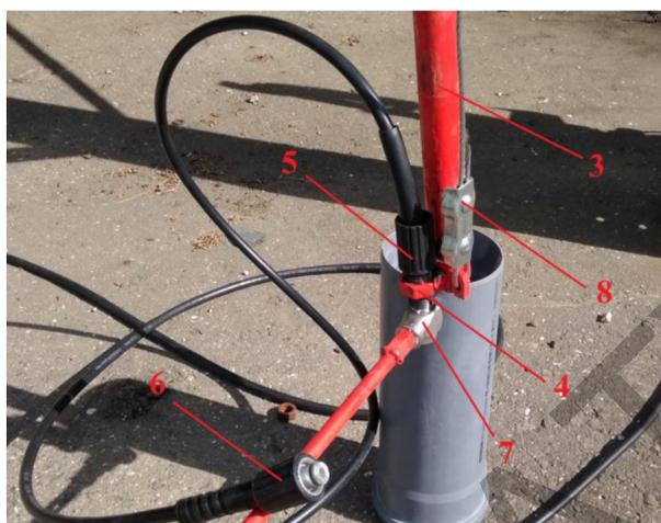
4 – штуцер; 5 – пневматическая магистраль высокого давления; 6 – гидравлическая магистраль высокого давления; 7 – поворотная муфта; 8 – устройство фиксации троса
