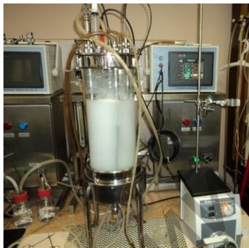
Рисунок 1 - Лабораторный биореактор
