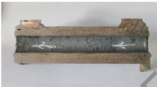
Рисунок 3 – Разрез горизонтальной формы с заготовкой
