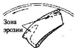
Рис. 7.7. Эрозия лопасти вентиляторов вблизи несущего диска
