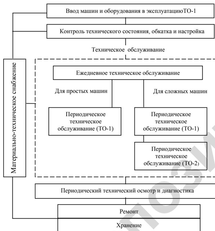
Рис. 1.2. Организационно-структурная схема технического обслуживания и ремонта животноводческого оборудования
