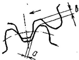
Рис. 2.17. Боковой ( $a$ ) и радиальный ( $b$ ) зазоры шестерен
