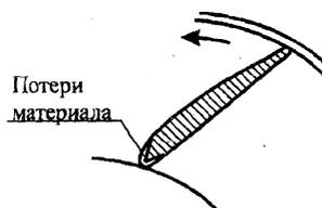
Рис. 7.6. Эрозия носовой части лопасти вентиляторов
