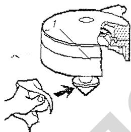
Рис. 4.80. Очистка конуса регулятора
