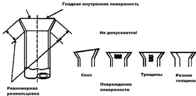
Рис. 5.91. Дефекты разбортовки трубки
