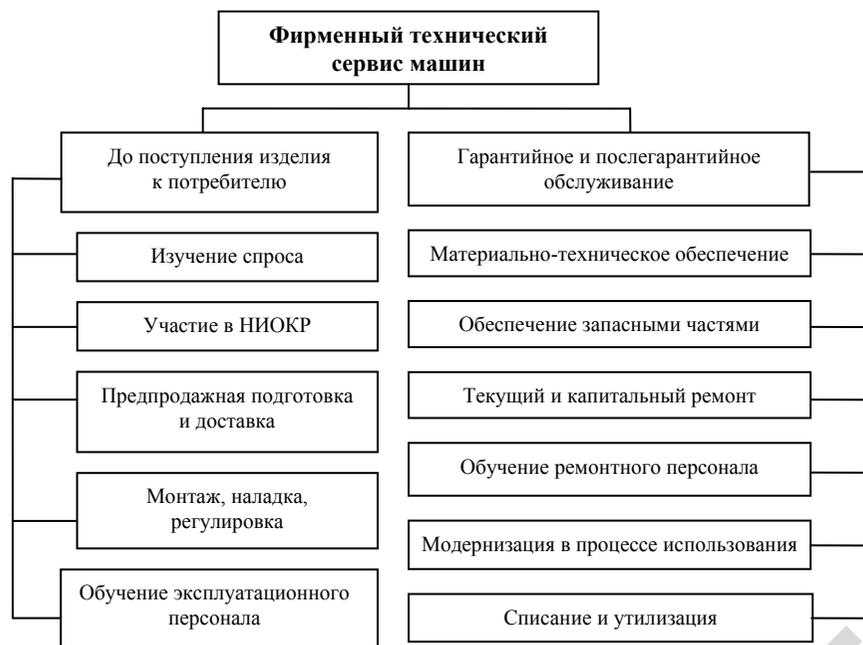
Рис. 1.1. Фирменный технический сервис машин и оборудования в течение их жизненного цикла
