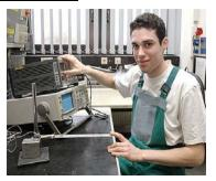
Ich löte die Leitung zusammen und prüfe anschließend, ob der Messstreifen wieder funktioniert. Dafür verwende ich ein Oszilloskop. Das zeigt mir den Spannungsverlauf im Dehnungsmessstreifen an.
