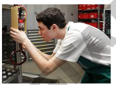
Als Nächstes muss ich ein Gerät montieren und anschließen, mit dem man Steuerungen von Motoren testet. Ich schraube alle dafür nötigen Bauteile an einem Gestell fest und verdrahte sie miteinander. Dabei orientiere ich mich an einem Aufbauplan und an Stromlaufplänen. Wenn ich
