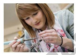
Jetzt löte ich Leitungen an einen Stecker. Erst schneide ich die Leitung zu, sodass sie genau in das Gerät passt. Bevor ich die Leitung anschließen kann, muss ich einen Teil der Isolierhülle, des sogenannten Mantels, mit einem speziellen Messer
