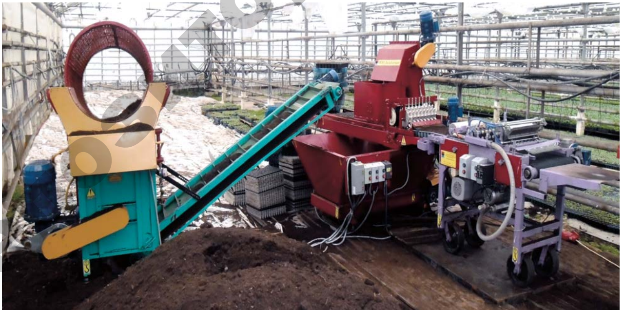
Рисунок 1. Технологическая линия заполнения кассеты субстратом и высева семян, разработанная в НИИМЭСХ БГАТУ, проходит испытания в УП «Агрокомбинат «Ждановичи»
