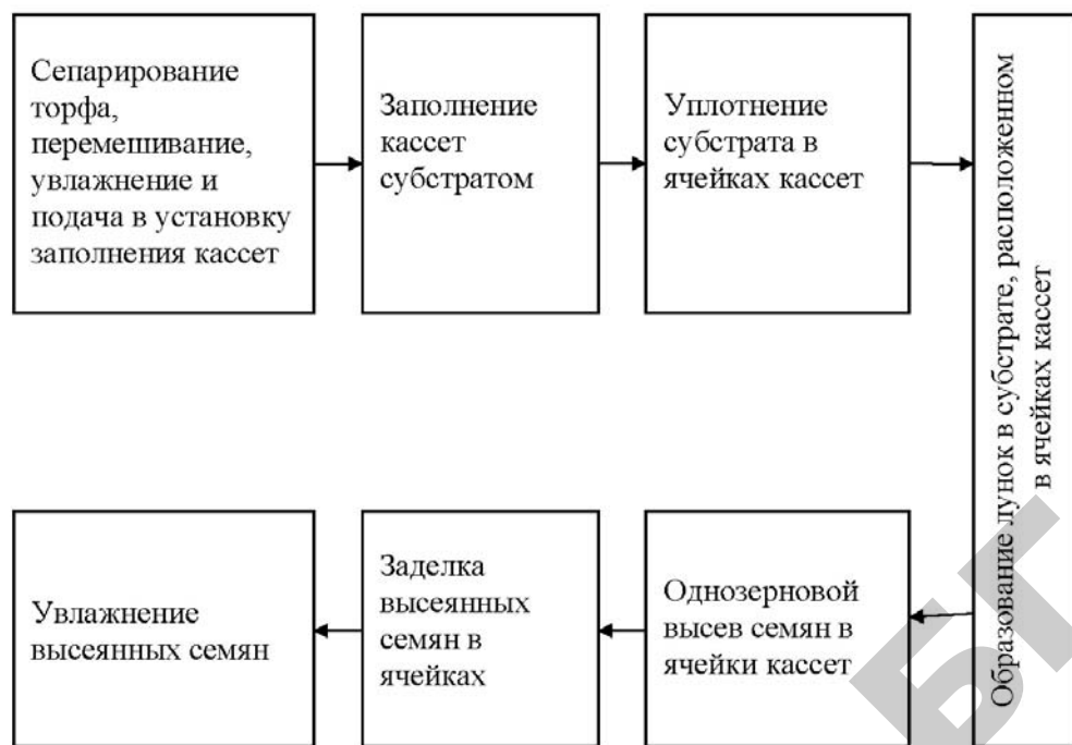
Рисунок 2. Схема порядка операций технологической линии заполнения кассет субстратом и высева семян овощных культур (ЛЗВ-300)
