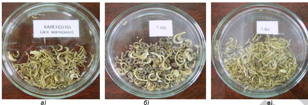
Рисунок 1. Электросепарация семенного вороха календулы: а) исходная семенная смесь; б) 1-я фракция (чистые семена) после электросепарации; в) 3-я фракция - «сход» с электросепаратора («цветочный мусор» - остатки семенного вороха)
