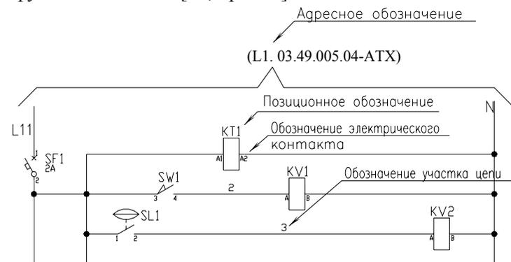
Рис. 28. Группы обозначений на чертеже принципиальной электрической схемы
