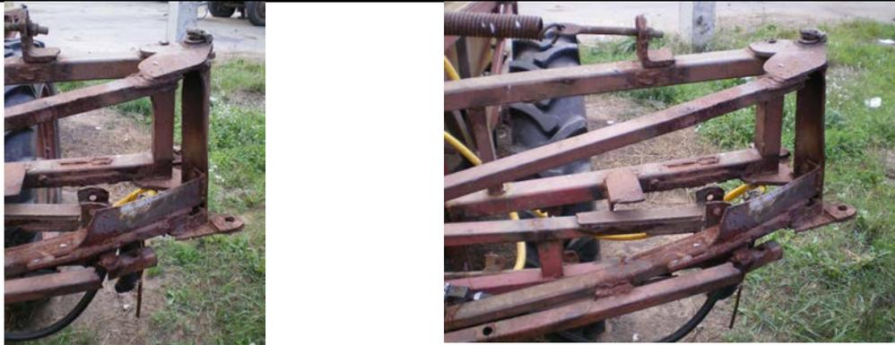
Рисунок 1 — Виды поломок несущей конструкции штанги опрыскивателя после нарушений требований эксплуатации
