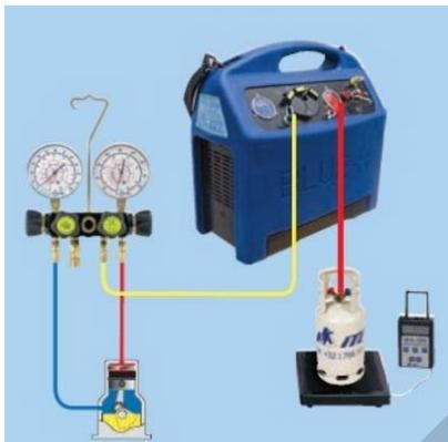
Рисунок 2 – Схема восстановления хладагентов прямым методом
