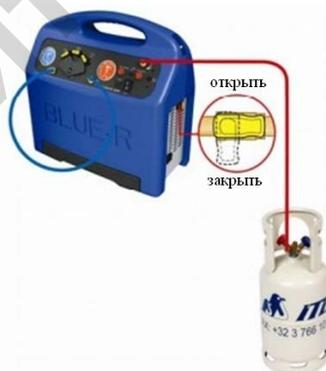
Рисунок 3 – Схема саморазгрузочного метода
