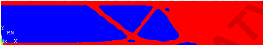
Рисунок 2 – Рекомендуемая форма конструкции, полученная после топологической оптимизации
