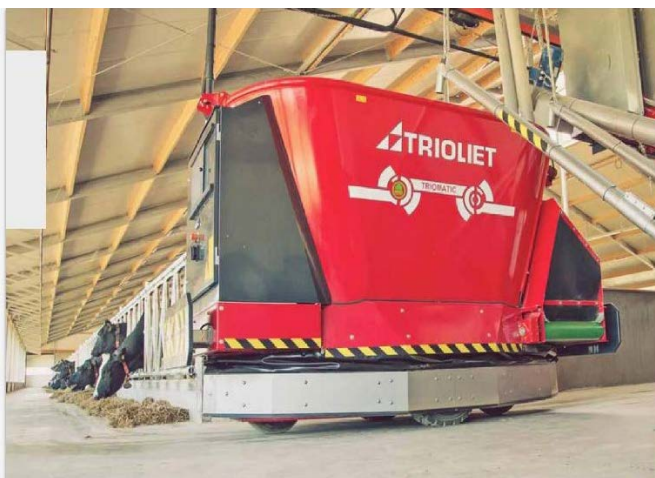
Рисунок 1 — TRIOMATIC WP 2 300 робот кормления с колесным приводом
