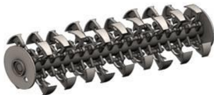
Рисунок 2 – Параметрическая модель ротора косилки
