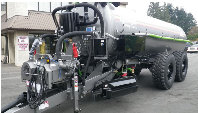
Рисунок 1 – Пневматическая машина для удаления полужидкого навоза из помещений КРС фирмы TOPIX AGRO 3125 Honey-VAC
