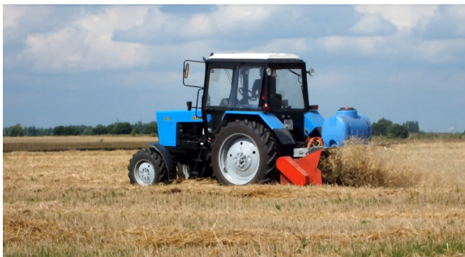
Рисунок 1 – Производственные испытания агрегата для утилизации незерновой части урожая в качестве удобрения
