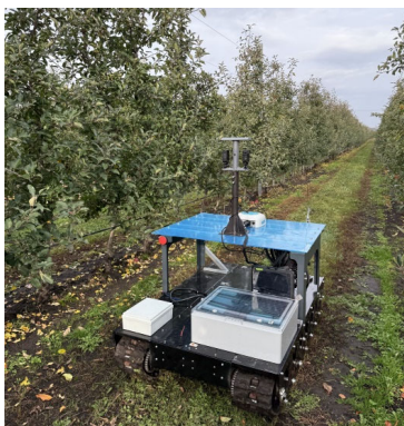
Рисунок 1 – Роботизированная гусеничная платформа для мониторинга садовых насаждений
