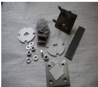
Рисунок 3 – Экспериментальный образец фильтроэлемента из ФМТС в разобранном виде ( a ) и в сборе ( б )
