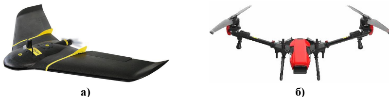
Рисунок 2 – Общий вид БПЛА а) с фиксированным крылом; б) с вращающимся крылом
