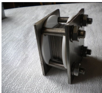
Рисунок 3 – Экспериментальный образец фильтроэлемента из ФМТС в разобранном виде ( a ) и в сборе ( б )
