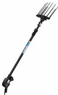
Рисунок 3 – Вибрационное устройство для сбора оливок
