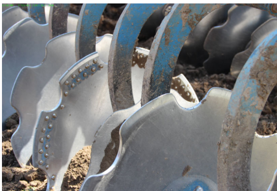
Рисунок 1 – Нанесенные износостойкие покрытия (точки) на почворезущую поверхность дискатора (апробация в полевых условиях)
