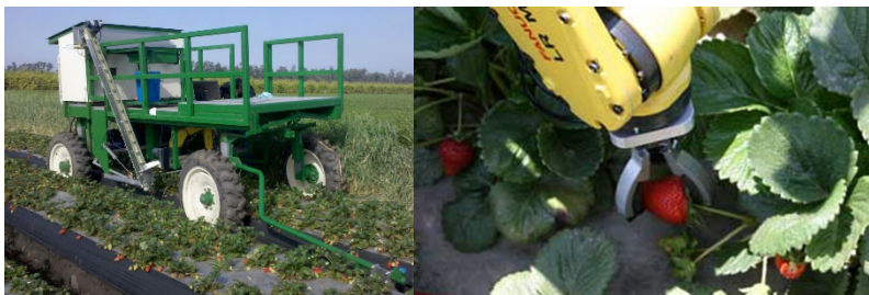
Рисунок 1 – Земляникоуборочный робот и его рабочий орган
