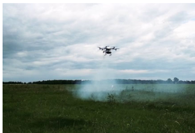
Рисунок 4 – Процесс генерации тумана сельскохозяйственным дроном
