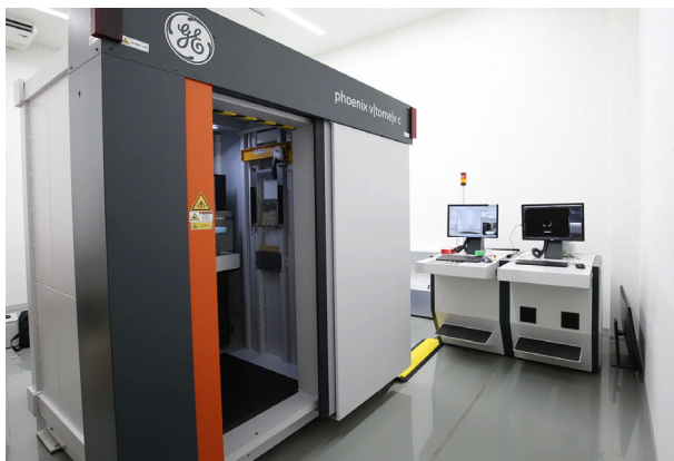
Рисунок 2 – Промышленный компьютерный томограф v/tome/x c450 (измерительный комплекс)
