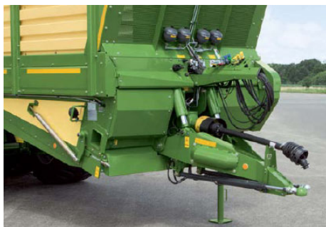
Рисунок 3 – Тягово-сцепное устройство прицепа Krone TX 460 / 560 с гидравлическим принудительным управлением [5]
