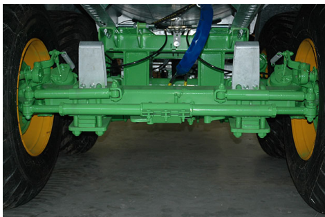
Рисунок 1 – Подруливающая ось Hydro-Tandem и Hydro-Tridem JOSKIN
