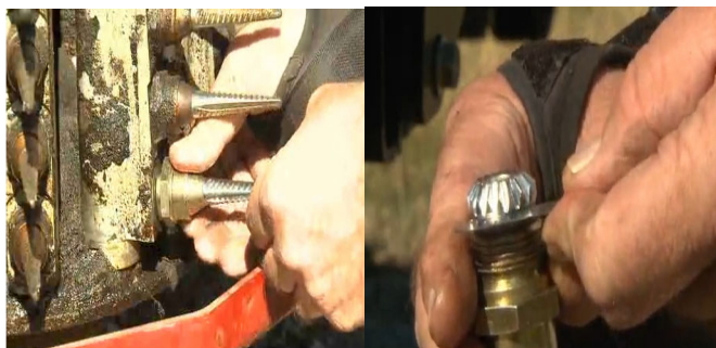
Рисунок 4 – Проверка состояния шпинделя и его втулки
