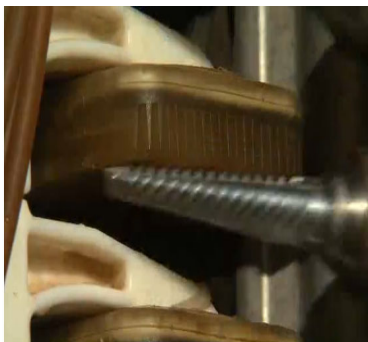
Рисунок 7 – Регулировка увлажнителя. 1 – болт держателя; 2 – регулировочная гайка; 3 – регулировочный кронштейн; 4 – стопорная гайка; 5 – узел увлажнителя шпинделя; 6 – увлажнитель; 7 – шпиндель
