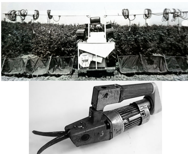
Рисунок 2 – Электроягодоборочная машина ЭЯМ-200-8 и её стряхивающий вибратор
