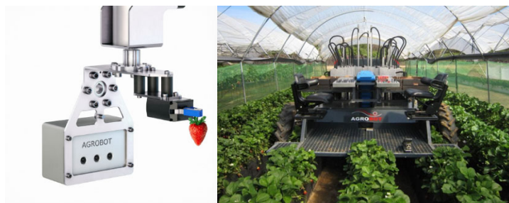
Рисунок 2 – Земляникоуборочная машина «Agrobot SW6010» и её рабочий орган
