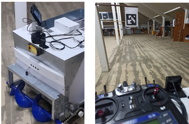
Рисунок 1 – Шнековое орудие с системой радиоуправления для автономного мобильного агробота
