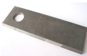
Рисунок 1 – Конструктивное исполнение ножа роторной косилки размером
