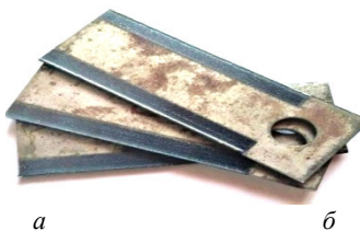
Рисунок 2 – Варианты поверхностной модификации ножа роторной косилки: а – состояние режущей кромки после электроискрового легирования; б – состояние поверхности после лазерной обработки
