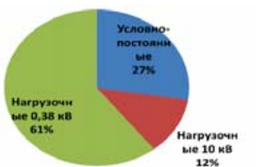
Рис. 1 Структура потерь электроэнергии в сетях 0,38-10 кВ РУП "Гомельэнерго"
