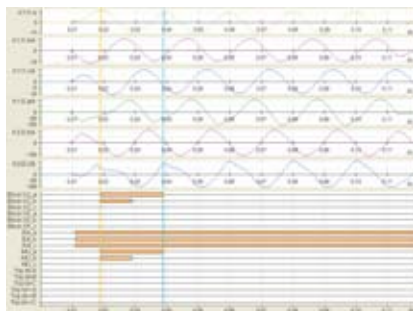
Рис. 2 – Осциллограммы трёхфазного КЗ.
