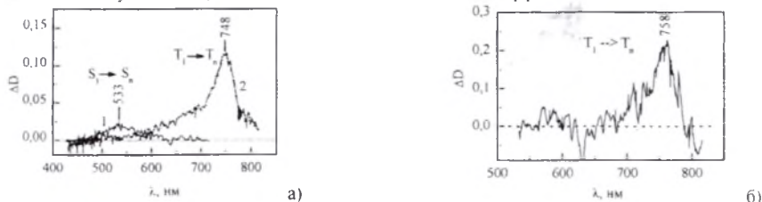
Рис. 2. Спектры наведенного поглощения раствора C_{60} в толуоле (а) и ТЭОС гель-матрице (б) при возбуждении третьей гармоникой Nd:YAG-лазера ( \lambda_{\text{возб}} = 354 нм, \tau_{\text{имп}} = 30 пс)
