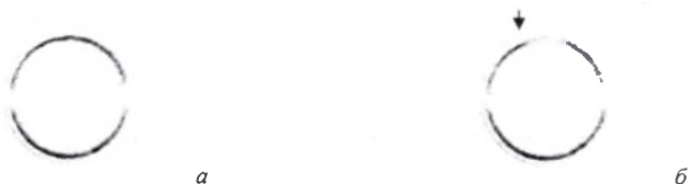
Рис. 2. Профилограммы образцов без (а) и с (б) поверхностными дефектами (изображение инвертировано, стрелкой указано место, соответствующее дефекту)
