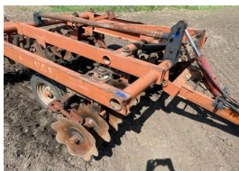
Рисунок 2 – Дисковая борона с установленным устройством для перераспределения веса
