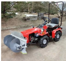
Рисунок 3 – Общий вид шнековый подталкиватель кормов производства фирмы ООО «Юликом Плюс» (Республика Беларусь)
