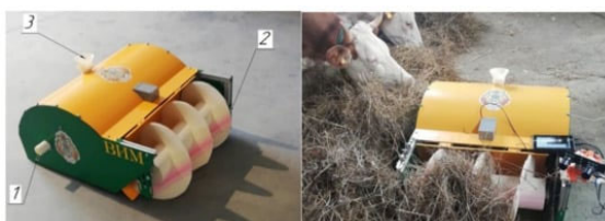
Рисунок 5 – Общий вид робота-подталкивателя; 1 – выход дозатора кормовых добавок; 2 – шнек-толкатель; 3 – наполнитель с доводчиком
