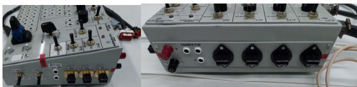
Рисунок 2 – Пульт проверки комплекта электронных блоков с соединительным жгутом: а) вид сверху; б) вид справа; в) вид слева; г) вид сзади
