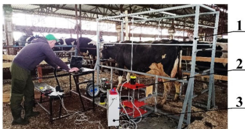
Рисунок 1 – Расположение лабораторной установки в хозяйстве: 1 – станок; 2 – манипулятор; 3 – блок управления
