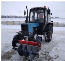
Рисунок 3 – Общий вид шнековый подталкиватель кормов производства фирмы ООО «Юликом Плюс» (Республика Беларусь)
