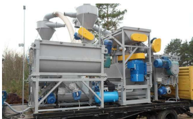
Рисунок 2 – Мобильный комбикормовый завод производительностью 4 т/ч
