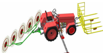
Рисунок 2 – 3D модель комбинированного агрегата для заготовки кормов
