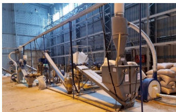
Рисунок 3 – Комплект оборудования КЛК-0,7 для производства легкоусвояемого концентрата
