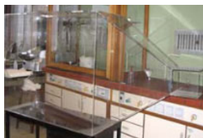
Рисунок 2 – Установки для исследования процесса сноса капель: 1 – заслонка; 2 – регулятор; 3 – вентилятор; 4 – распылитель; 5 – обрабатываемая поверхность (макет гребня); 6 – дополнительная приемная поверхность; 7 – мерные цилиндры
