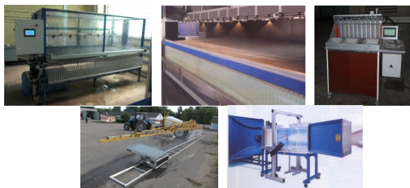
Рисунок 1. – Стенды и лабораторные установки для исследования гидравлических распылителей полевых опрыскивателей
