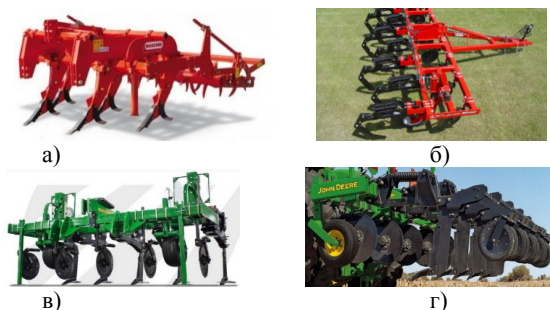
Рисунок 2 – Глубококорыхлители, производимые за рубежом: а) Pinocchio 300/7; б) Wil-Rich 357; в) Great Plains SS 1300; г) John Deere 913/915
