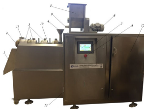
Рисунок 1– Экструдер KDL30-IV: 1 – выгрузочный желоб, 2 – матрица с фильерой, 3 – греющие элементы рабочей камеры, 4 – загрузочная воронка, 5 – шнековый питатель, 6 – электропривод питателя, 7 – сенсорный пульт управления, 8 – кнопка аварийной остановки, 9 – шнек питателя, 10 – рабочая камера, 11 – привод ножа, 12 – шкаф, 13 – корпус экструдера
