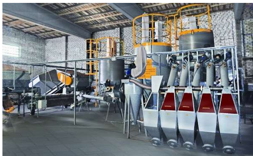
Рисунок 1 – Комплект оборудования для производства белково-витаминных добавок (БВД) на основе рапсового жмыха КДР-0,8
