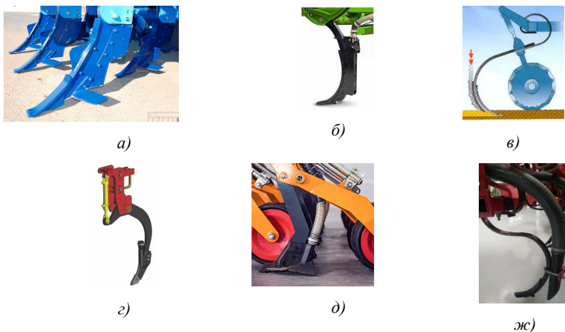
Рисунок 2 – Устройства для локального внесения удобрений: а) Farmet Fertis 4,5 (Чехия); б) Amazone (Германия); в) Horsch (Германия); г), д) Mzuri (Великобритания); ж) экспериментальный завод НПЦ НАН Беларуси по механизации.
