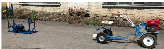
Рисунок 4 – Стенд для определения усилия на перекачивание и буксование
