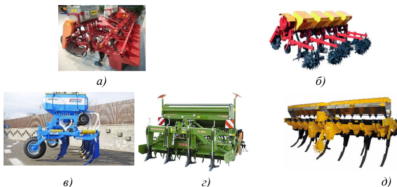
Рисунок 1 – Культиваторы для локального внесения удобрений: а) культиватор-окучник растениепитатель КОР-4; б) культиватор-окучник навесной КОН-2,8; в) глубокорыхлитель Farnet Fertis 4,5 (Чехия); г) глубокорыхлитель Amazone TL; д) глубокорыхлитель STG 9-400.
