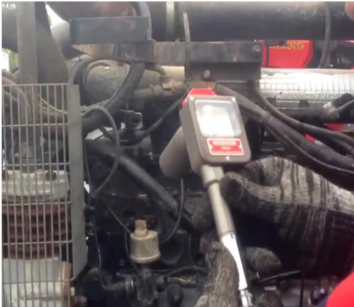
Рисунок 4. Измерение компрессии в цилиндрах дизеля Д-260.2 с помощью электронного индикатора (компрессометра) W800/500
