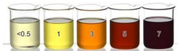
Рисунок 8 – Цифровое изображение моторных масел с баллами по шкале ASTM D 1500
