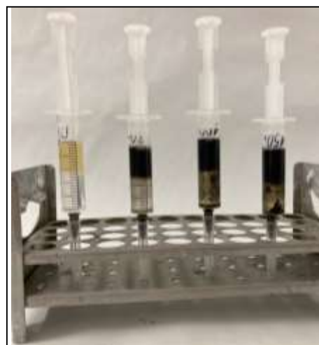
Рисунок 2 – Шприцы после отстаивания водно-спиртового раствора и моторного масла
