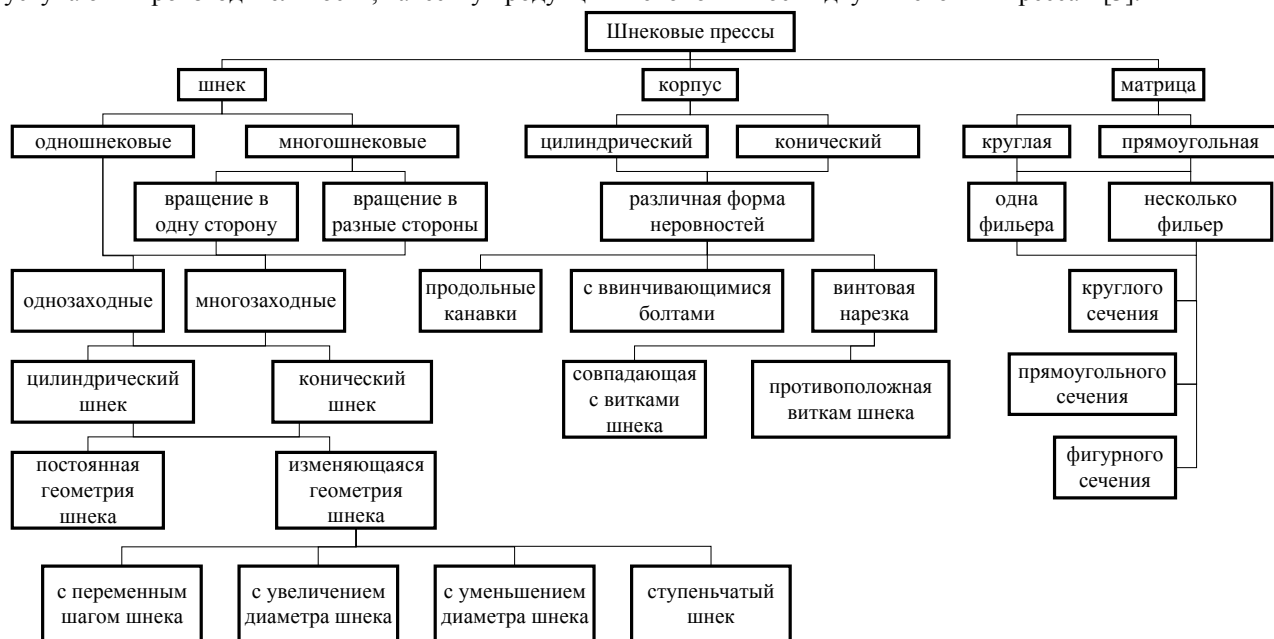
Рисунок 1 – Классификационная схема шнековых прессующих механизмов
