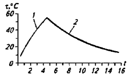
Рис. 1. Кривые нагрева (1) и охлаждения (2) ЭД
