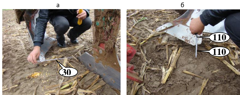
Рисунок 7 – Ширина захвата лемешно-отвального расширителя борозды 300 мм (а) и высота установки лемешно-отвального расширителя борозды по отношению к основному корпусу половина глубины обработки почвы (б)
