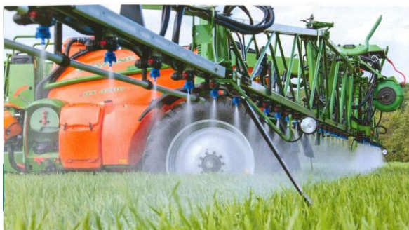
Рисунок 4 - Работа инжекторных распылителей на опрыскивателе фирмы AMAZONE
