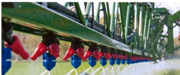
Рисунок 5. Работа штанги с двухцелевыми распыляющими устройствами
