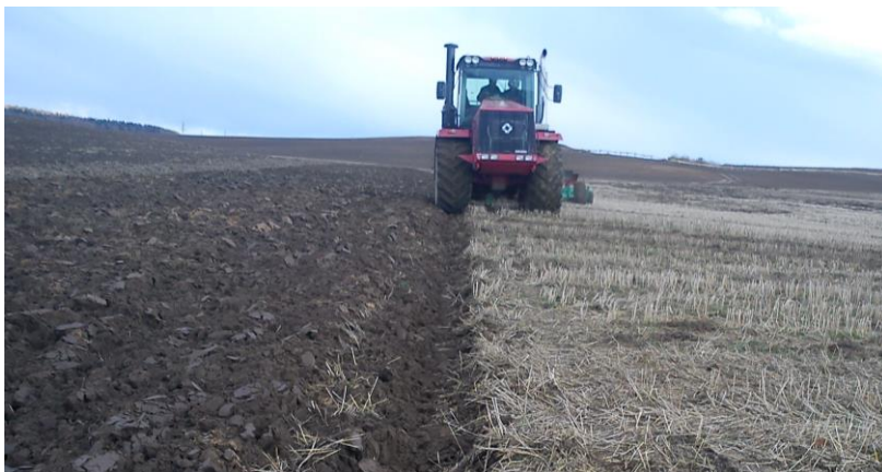
Рисунок 12 – Слитная и равноглубинная пахота плугом ППО-9-45+1-30 при вождении трактора К-744 Р2 правым (или левым) бортом в полуборозде (1-ая Минская птицефабрика, 16 апреля 2014 год)
