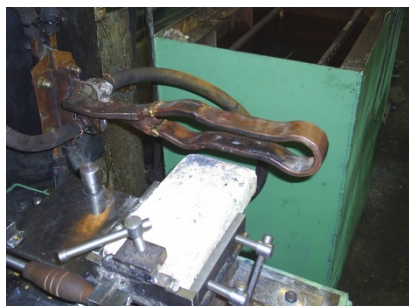
Рисунок 2 - Процесс индукционной наплавки на РОПМ: а – наплавочный индуктор; б – наплавляемое долото
