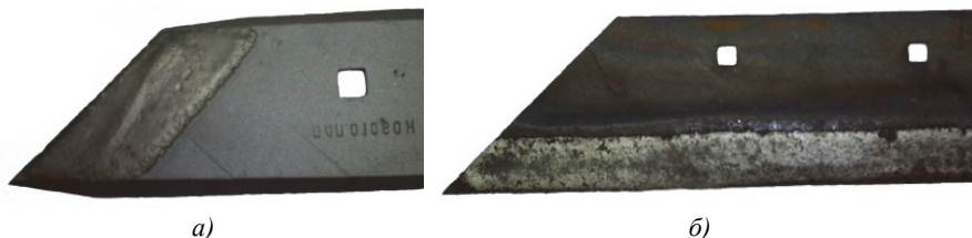
Рисунок 4 - РОПМ с наплавленными покрытиями из ДЛ чугуновой дроби: а – долото; б - лемех
