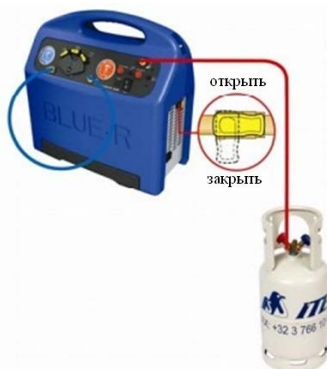
Рисунок 3 – Схема саморазгрузочного метода
