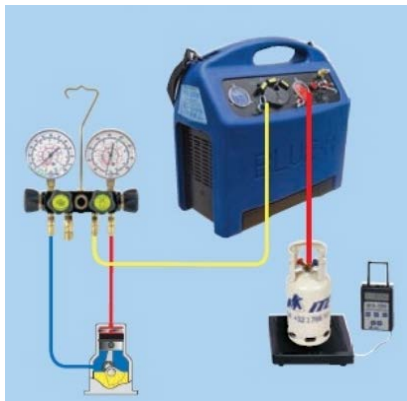
Рисунок 2 – Схема восстановления хладагентов прямым методом
