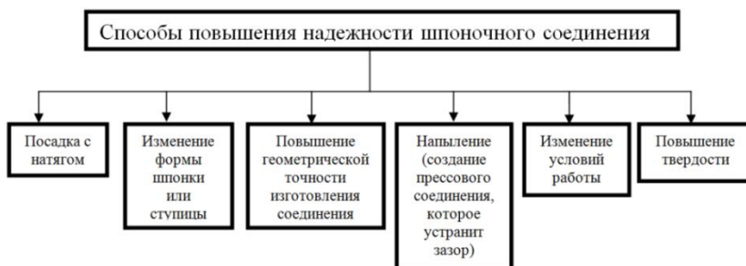
Рисунок 2 – Способы повышения надежности шпоночного соединения
