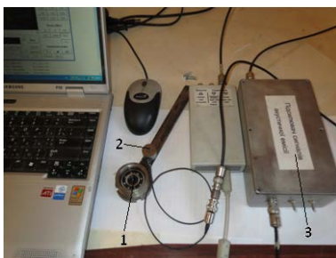
Рисунок 1 - Внешний вид устройства для исследования противопиттинговых свойств масел:
