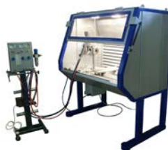
Рисунок 4 - Камера полу-автоматического напы-ления ТЕНА-КПАН-1300 с установкой газопламенно-го напыления ТЕНА-Ппм
