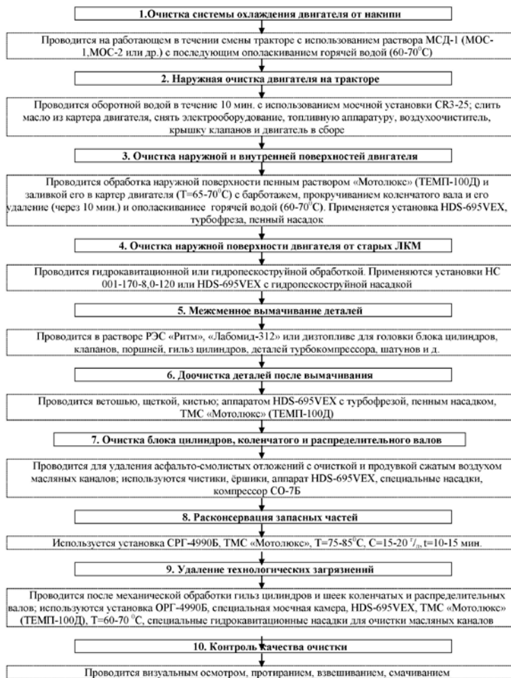
Рисунок 1 – Схема технологического процесса очистки двигателя и его деталей при ремонте
