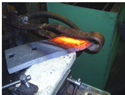
Рисунок 2 - Процесс индукционной наплавки на РОПМ: а – наплавочный индуктор; б – наплавляемое долото
