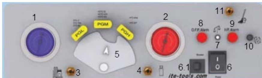
Рисунок 1 — Схема передней панели станция восстановления и очистки хладагента BLUE-R-95:
