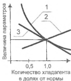
Рис. 2. Изменение диагностических показателей молокоохладительной установки в зависимости от наличия хладагента:
