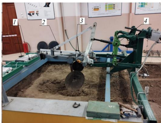
Рисунок 1. – Лабораторная установка для исследования работы дискового предплужника
