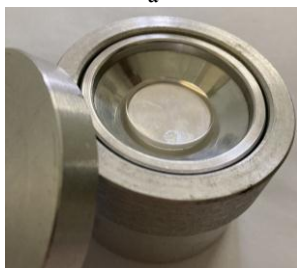
Рисунок 1. – Электротигель со специальными приспособлениями для определения наличия и количества воды в моторном масле: а – схема; б – внешний вид; 1 – электротигель; 2 – свеча накаливания; 3 – аккумулятор; 4 – цилиндрическая вставка; 5 – визуализирующее стекло; 6 – термopара; 7 – система контроля и регулирования температуры
