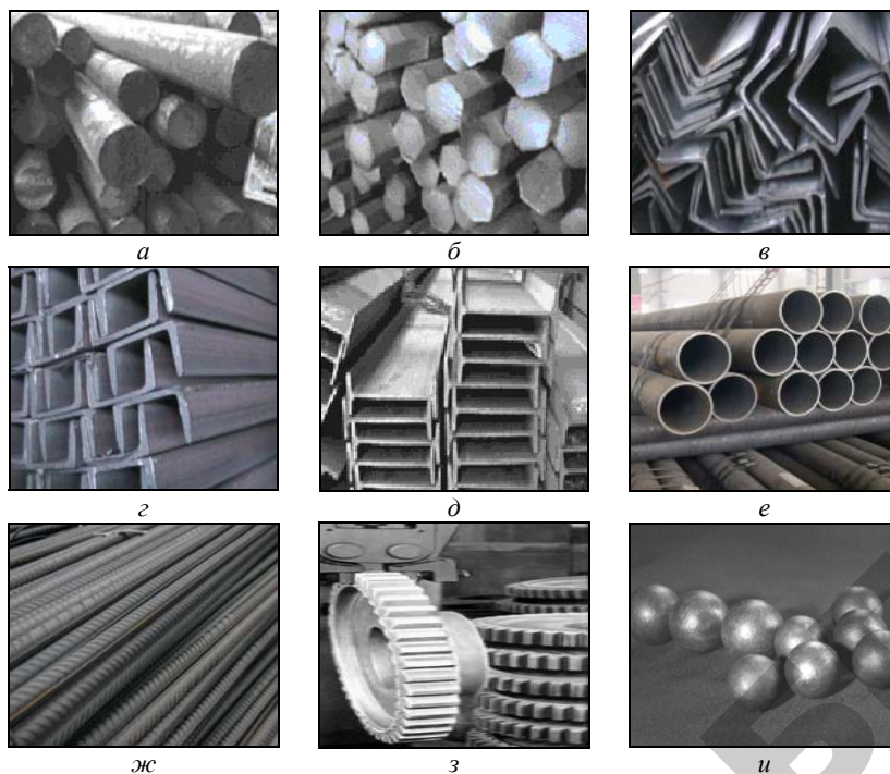
Рис. 2.23. Виды продукции прокатного производства: а — прокат круглый; б — прокат шестигранный; в — уголок равнополочный; г — швеллеры; д — двутавры; е — трубы; ж — арматура периодического профиля; з — зубчатые колеса; и — шары мелющие для шаровых мельниц
