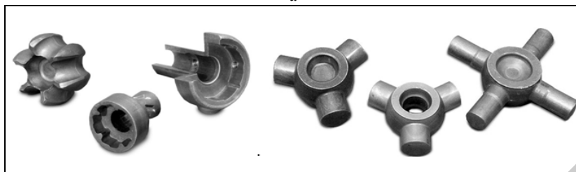
Рис. 2.46. Примеры деталей, полученных холодной объемной штамповкой: a — холодная высадка метизов; б — холодное выдавливание деталей сложной формы
