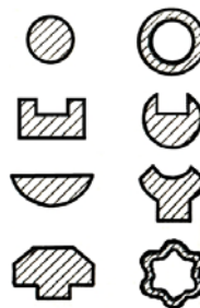
Рис. 2.29. Профили, получаемые волочением
