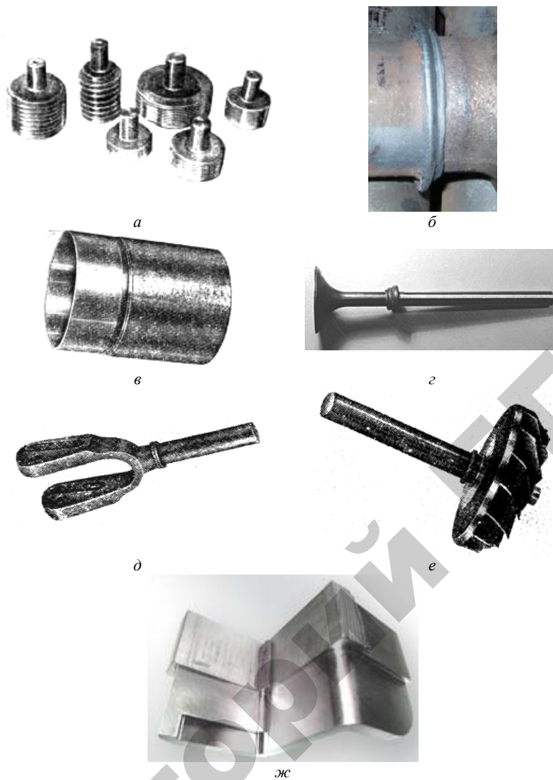
Рис. 3.61. Применение сварки трением: а — гладкие и резьбовые калибры; б — сварка труб; в — сталеалюминевый трубчатый переходник (диаметр — 90 мм, толщина стенки — 4 мм); г — клапан ДВС; д — вилка тяги (поковка и прокат); е — ротор турбоагнетателя (колесо из жаропрочной аустенитной стали, вал — из перлитной стали); ж — соединение пластин линейной сваркой
