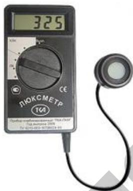
Рис. П2.3. Общий вид люксметра ТКА ЛЮКС
