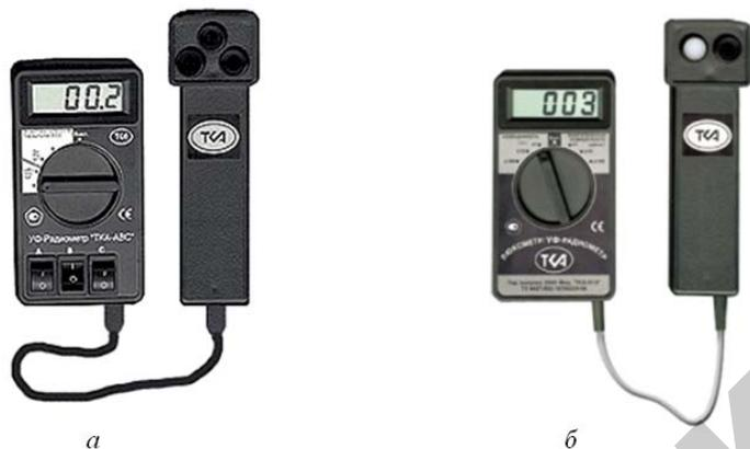
Рис. П2.6. Общий вид радиометра ТКА-ПКМ (а) и люксметра + радиометра ТКА-01/3 (б)
