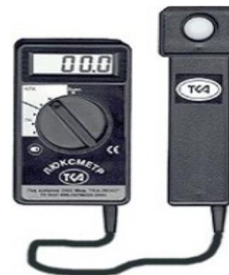
Рис. П2.2. Общий вид люксметра ТКА-ПКМ/31
